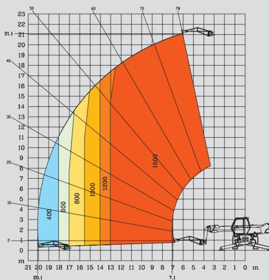
**ROTAZIONE SU STABILIZZATORI COMPLETAMENTE SFILATI CON CESTELLO AERIAL JIB**
