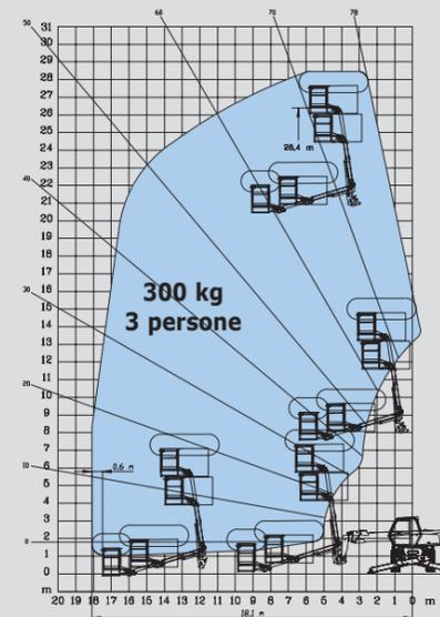
**ROTAZIONE SU STABILIZZATORI COMPLETAMENTE SFILATI CON CRANE JIB**
