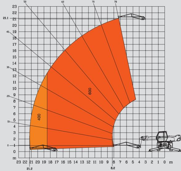
**ROTAZIONE SU STABILIZZATORI COMPLETAMENTE SFILATI CON BRACCETTO P 1500**
