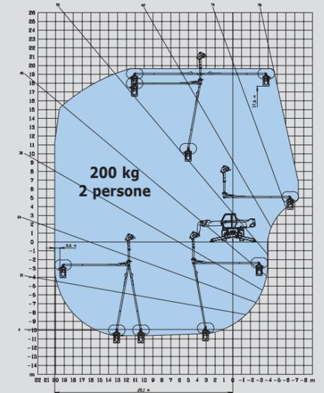
**ROTAZIONE SU STABILIZZATORI COMPLETAMENTE SFILATI CON BRACCETTO P 600**
